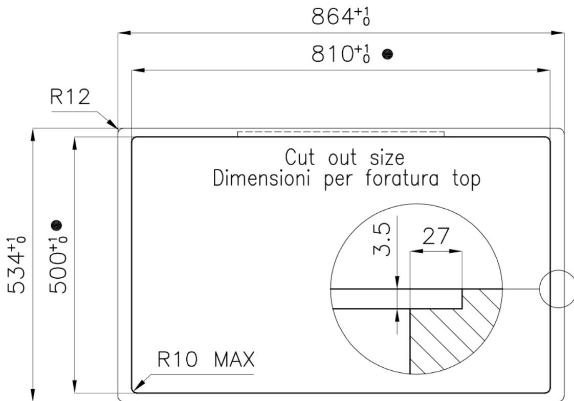
● Built-in cut out for FTS – Foratura per installazione FTS
